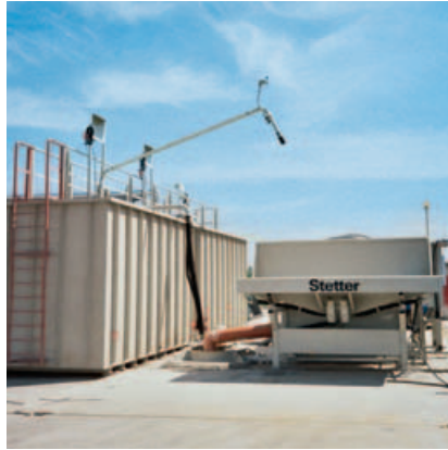
Ejecución sobre suelo con contenedor doble para la acumulación intermedia del agua fangosa, recomendable para sustratos rocosos o aplicaciones móviles.
