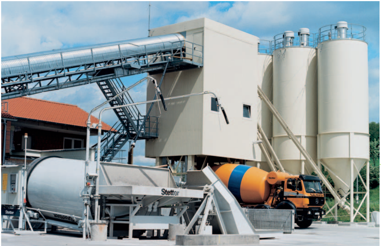
RA 20 con tolva de alimentación rectangular de 3,2 m de anchura, dos plumas de agua y alimentador opcional.
