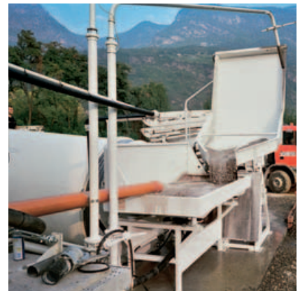
Alimentador accionado hidráulicamente para la recepción de productos residuales desde autobombas de hormigón, 1.100 l de capacidad.
