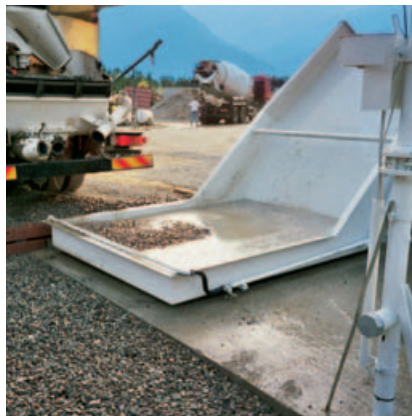
Alimentador accionado hidráulicamente para la recepción de productos residuales desde autobombas de hormigón, 1.100 l de capacidad.
